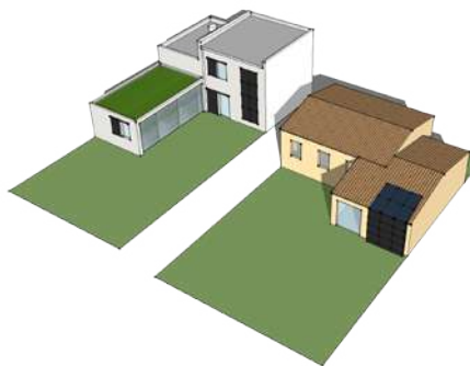
Panneaux implantés en façade
