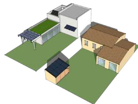
Panneaux implantés sur annexes, en brise-soleil
